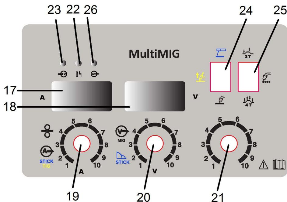
17. Цифровой индикатор (отображает установленное и измеренное значение сварочного тока)
